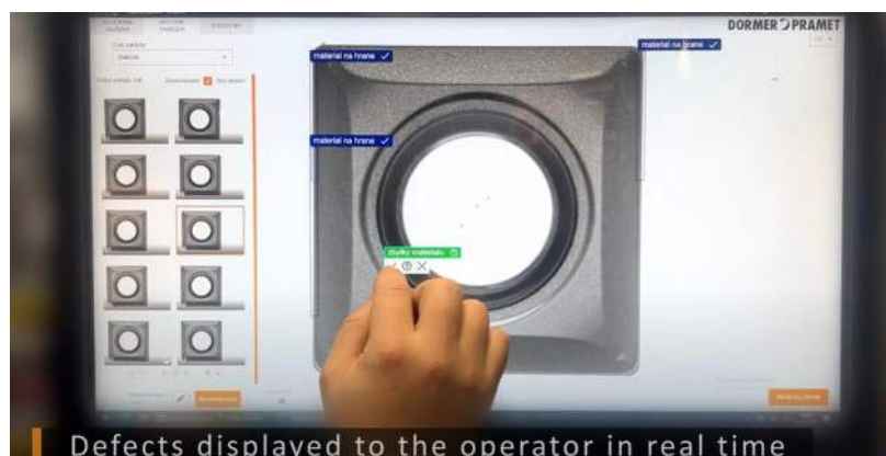
Рисунок 2 - Процес перевірки відбувається під час пресування поки машина працює [2]
