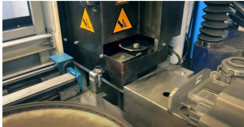
Рисунок 1 - Станція контролю здатна самостійно контролювати та оцінювати візуальні дефекти, що виникають у процесі виробництва ріжучих пластин [2]
