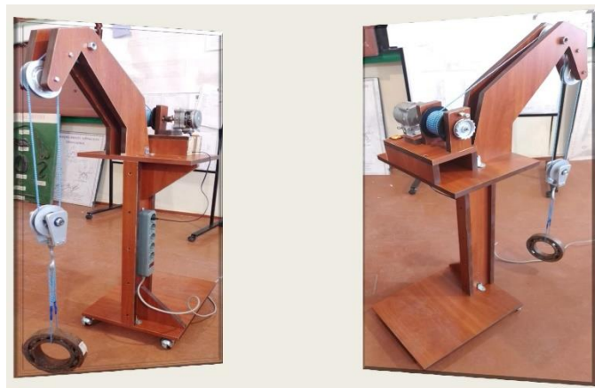
Рисунок 2 – Навчальна модель вантажопідйомного крана.
