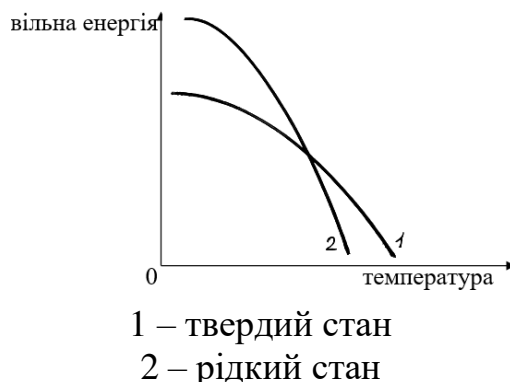
Рисунок 3.2 – Характер залежності вільної енергії сплаву від температури
